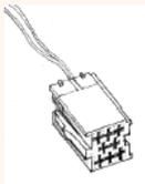
Falls das Fahrzeug nur mit Radiovorbereitung ausgestattet ist (ohne Quadlock Stecker): zum Beispiel ist bei der B-Klasse der CAN-Bus im Beifahrer Fussraum oben links neben der Hauptstromversorgung (Relaiskasten) zu finden. Die verdrehten Leitungen des Innenraum CAN-Bus haben hier die Farbkennung braun-rot für CAN high und braun für CAN low.
