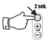
Sie können keinen zweiten ankommenden oder abgehenden Ruf über die VoiceDial Taste bedienen. Dieses geht nur über die Tastatur Ihres Mobiltelefons. Während des Stand-by-Modus aktivieren Sie durch kurzes Drücken (bis 1,5 sec) der VoiceDial-Taste die Sprachsteuerung. Ein Kontrollton signalisiert Ihnen die Kommunikationsbereitschaft der Freisprecheinrichtung.
