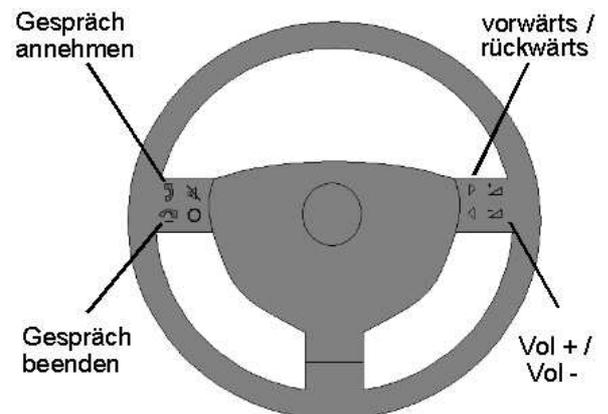
Um weitere Informationen über das verwendete Mobiltelefon oder die Freisprechanlage zu bekommen, lesen sie bitte die Bedienungsanleitung des jeweiligen Gerätes. Grundsätzlich unterstützt die Fernsteuerung mit unserem CAN-Bus Adapter alle Funktionen die mit der originalen Fernbedienung CU-7 möglich sind.
