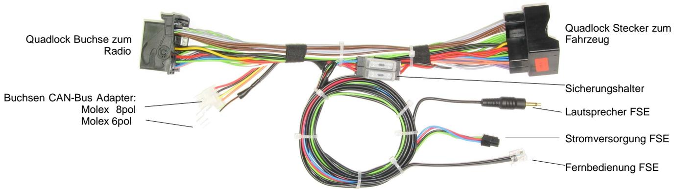
Es wird die Nokia Fernbedienung (CU-7) ersetzt. Die mittlere Taste der Fernbedienung („Fernbedienungstaste“) wird durch die „Gespräch annehmen“-Taste am Multifunktionslenkrad ersetzt. Bei aktiver Freisprechanlage (Mute-Zustand des Radios) ersetzen die Lenkradtasten „lauter“ und „leiser“ das Einstellrad an der original Nokia Fernbedienung. Lesen Sie hierzu die Bedienungsanleitung der Freisprechanlage.
