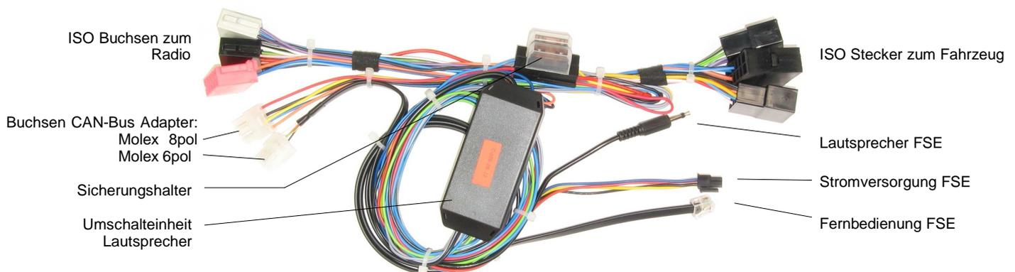
Es wird die Nokia Fernbedienung (CU-7) ersetzt. Die „mittlere Taste“ der Fernbedienung wird durch die Tasten „Anruf annehmen/Telefon auflegen“ am Multifunktionslenkrad ersetzt. Beide Tasten sind in ihrer Funktion gleich und können daher wahlweise verwendet werden. Bei aktiver Freisprechanlage (Mute-Zustand des Radios) ersetzen die Lenkradtasten „lauter“ und „leiser“ das Einstellrad an der original Nokia Fernbedienung. Lesen Sie hierzu die Bedienungsanleitung der Freisprechanlage.
