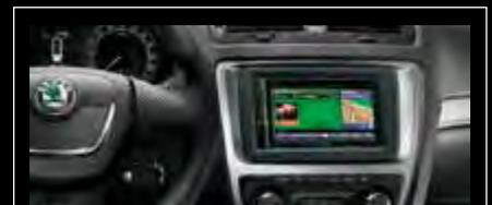
Einbausatz auch kompatibel mit Seat Leon II, Altea, Toledo III sowie Skoda Superb II, Octavia II, Yeti, Fabia, Roomster (im Falle eines Steuergeräts, das nicht der VW-Form entspricht, ist eine original werkseitige Blende erforderlich).
