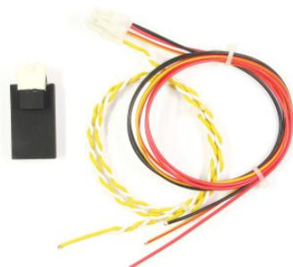
Das elektronische Lastrelais „ER-70“ ist für alle Fahrzeuge mit 12V Bordspannung geeignet. Ein positives Steuersignal oder ein Massesteuersignal schaltet stromlos eine Last von bis zu 70 W, beziehungsweise kurzfristig bis zu 90 W. Durch die äußerst geringe Belastung der Steuerspannung können auch Signale aus überwachten Stromkreisen abgegriffen werden (z. B. keine Fehlermeldung bei Bordcomputer mit Lampen-Defekt-Erkennung).
