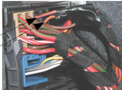
Falls am Radiostecker kein CAN-Bus zu finden ist, kann er sich an der Rückseite des Klimabedienelementes befinden.
