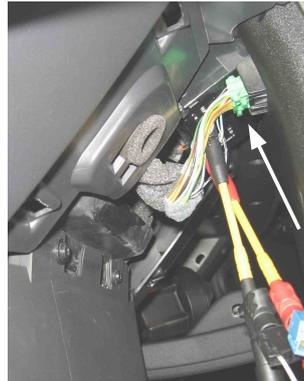
Der grüne Stecker zur Bedientafel wird sichtbar.
