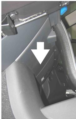
Abdeckung hinter der Bedientafel senkrecht nach unten abziehen.
