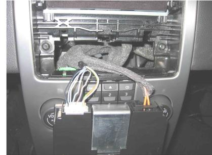
Der Rahmen ist geklipst. Die Rastnasen mit geeignetem Werkzeug von innen nach außen drücken und gleichzeitig den Rahmen nach vorne ziehen.
